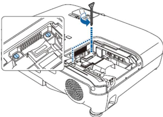
**6** Entfernen Sie die Lampe am Lampengriff an und ziehen Sie die Lampe vorsichtig aus dem Projektor
