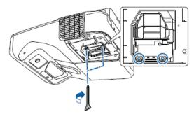
Bringen Sie die Lampenfachabdeckung wieder an und ziehen Sie die Schraube zur Sicherung fest.
