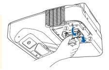
Setzen Sie die neue Lampe vorsichtig in den Projektor ein. Falls sie nicht problemlos passt, prüfen Sie bitte die Ausrichtung. Drücken Sie den Griff nach oben.
