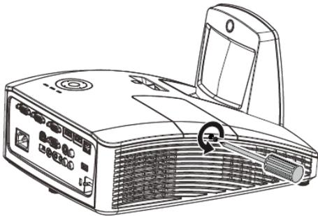
2. Entfernen Sie die Abdeckung des Lampenfachs.
