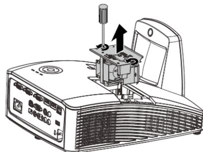
6. Befolgen Sie zur Installation des neuen Lampenmoduls die Schritt 1 bis 5 in umgekehrter Reihenfolge. Richten Sie bei der Installation das Lampenmodul aus; achten Sie zur Vermeidung von Schäden darauf, dass es gerade ist.
